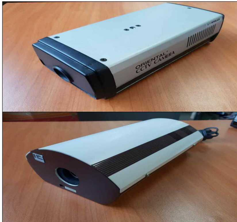
<그림 II-5> C 마운트 형 진공관 카메라 종류
