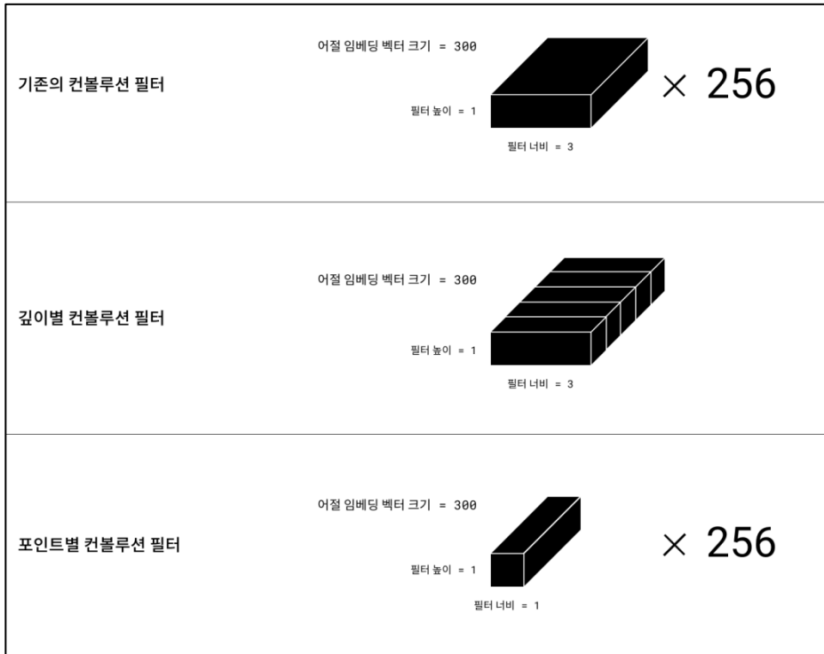
그림 18 기존 컨볼루션 연산과 깊이 분리 컨볼루션에 사용하는 필터 예시
