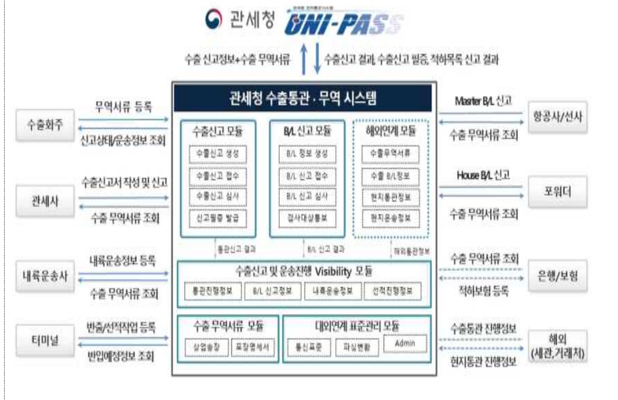
<그림 III-2> 블록체인 기반의 수출통관 시스템 개념도
