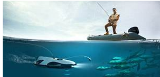
파워비전 테크놀로지 그룹, 음파탐지기, LED 조명, 비디오와 사진 촬영, 와이파이 송수신기를 탑재한 수중 드론 PowerRay 개발
