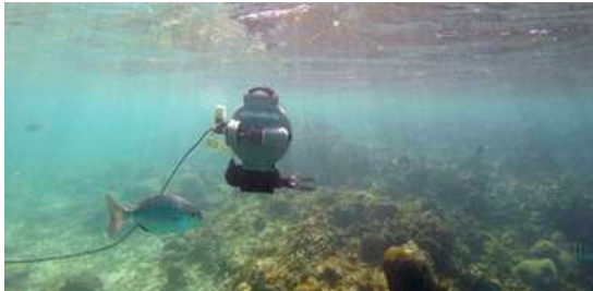
딥트레커(Deep Trekker)사, 드론에 진공 흡착 시스템을 부착하여 어류의 사체를 수거하여 지상에서 검사
